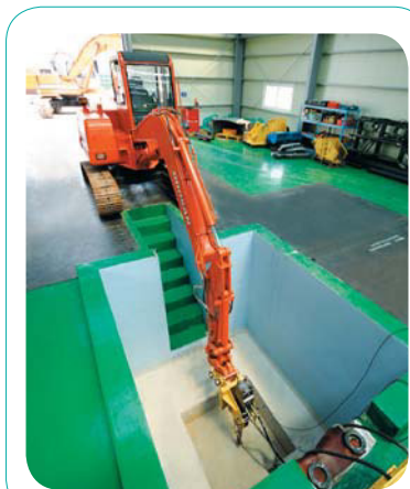
Объект испытаний устанавливается на основании для выполнения удара, соединенное с деформационным манометром в наконечнике и измерителем потока и измерителем давления на отверстиях цилиндра для подсоединения шланга
