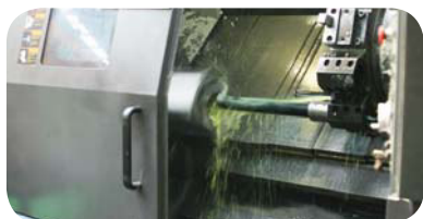
Токарный станок с ЧПУ типа CNC Сверление отверстий вращающимся инструментом
