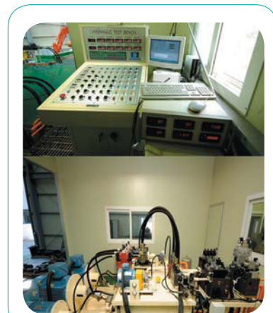
Пульт управления с монитором. Блок питания для воспроизведения реальной ситуации
