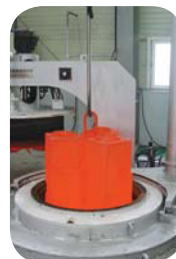
Извлечение деталей из закалочной печи для переноса в бак масляного охлаждения.
