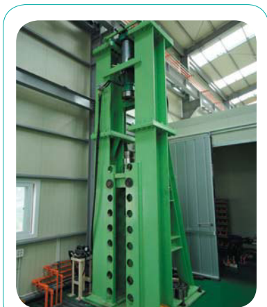
Контрольно-проверочный стенд статической калибровки для правильного измерения
